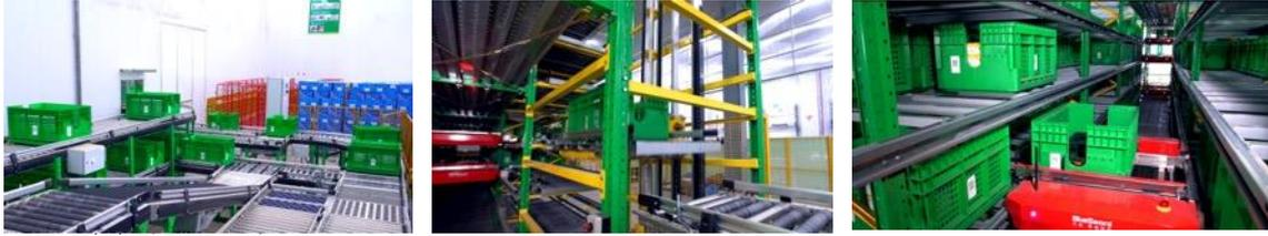
多穿系统根据订单出库顺序，通过穿梭车、提升机、输送线依次将商品输送至拣选台；
