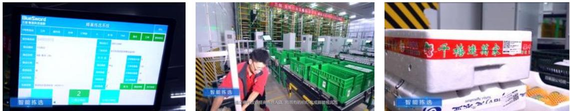
通过六轮车对 BC 类商品码垛，订单拣选完成后放至缓存区域，由司机拉至月台集货，现控人员手持确认集货的门店商品是否到齐，确认后由司机手持逐件扫码装车；
